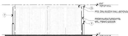
A1 DUMPSTER ENCLOSER FRONT ELEV. SCALE: 3/16" = 1'-0"
