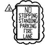
10 FIRE LANE SIGN DETAIL A100 N.T.S.
